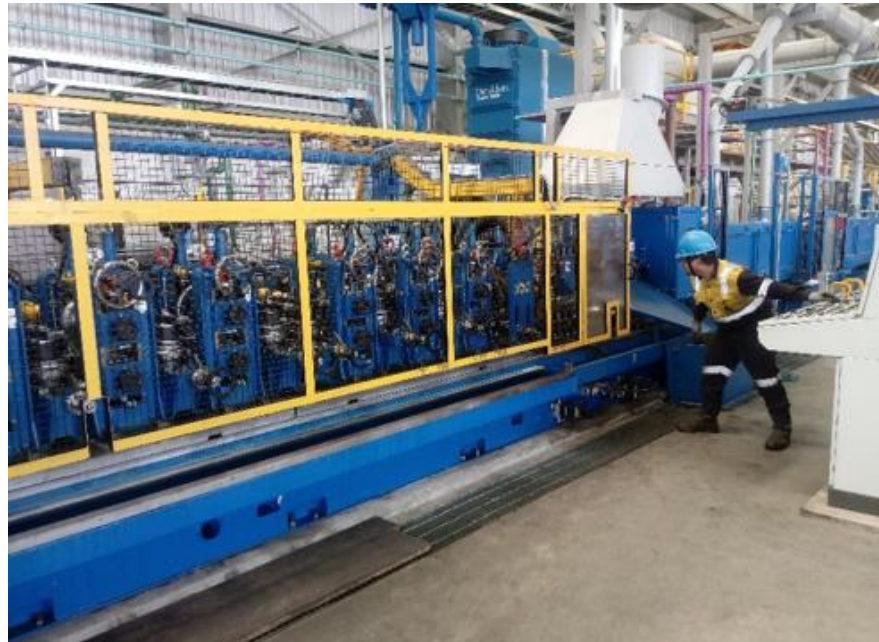
Molino Formador de tubos
