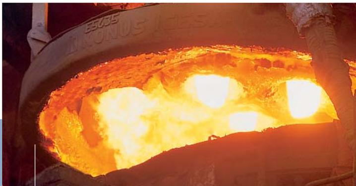
Apertura de la bóveda del Horno Eléctrico:
