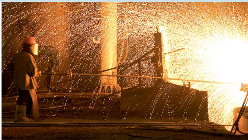
Inyección de oxígeno criogénico de alta pureza al horno eléctrico para acelerar el proceso de fusión de la carga metálica.
