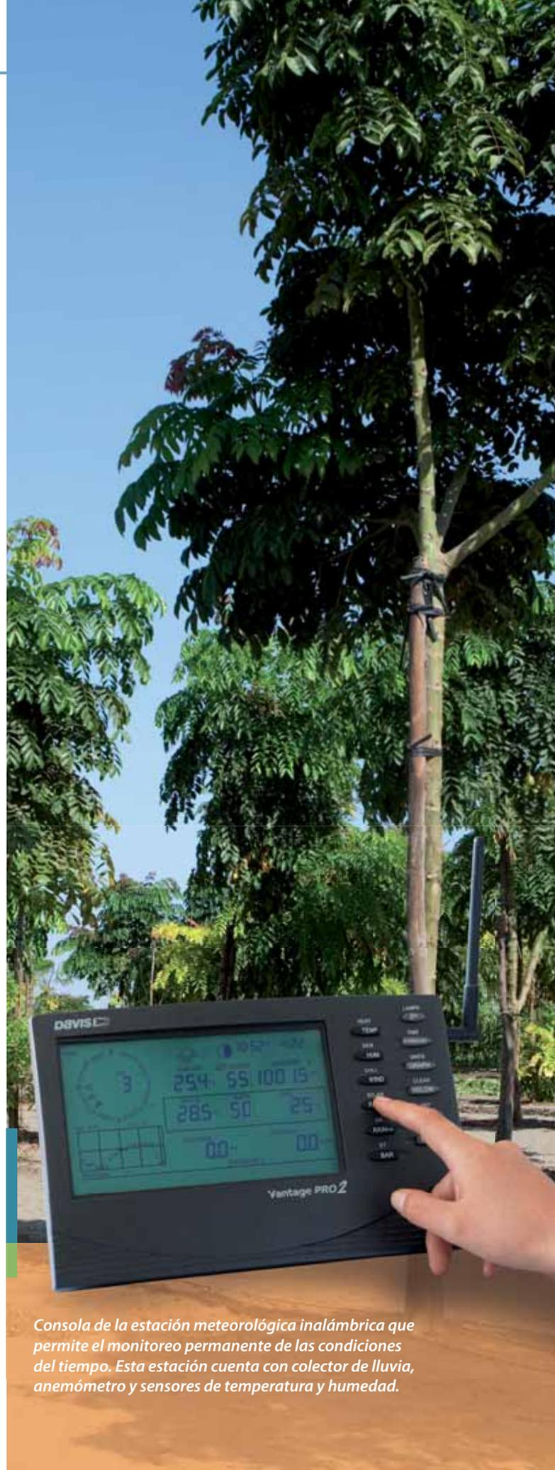
*Consola de la estación meteorológica inalámbrica que permite el monitoreo permanente de las condiciones del tiempo. Esta estación cuenta con colector de lluvia, anemómetro y sensores de temperatura y humedad.*
