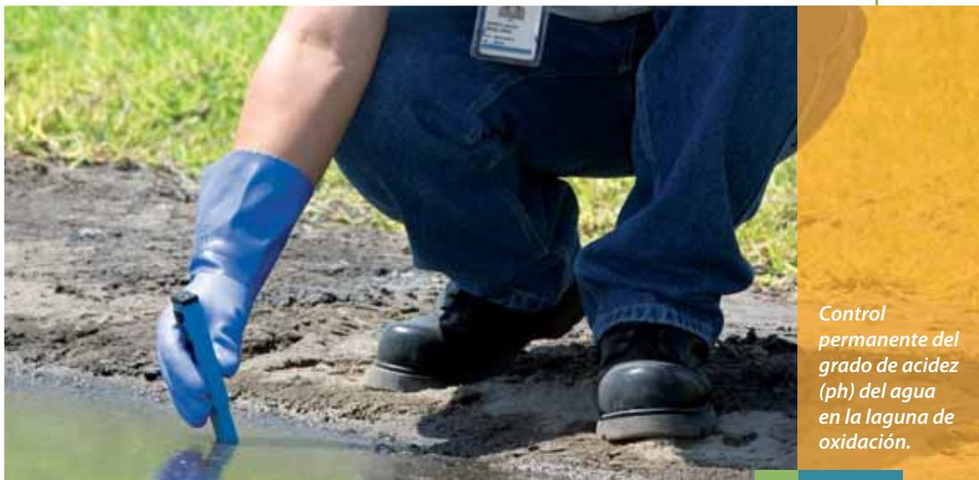
*Control permanente del grado de acidez (ph) del agua en la laguna de oxidación.*
