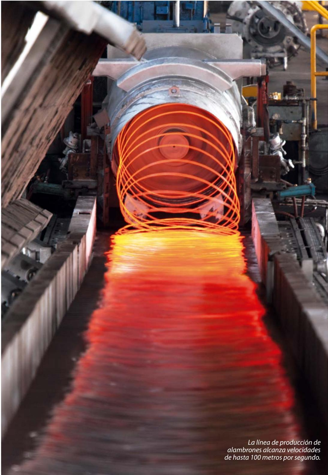
*La línea de producción de alambres alcanza velocidades de hasta 100 metros por segundo.*
