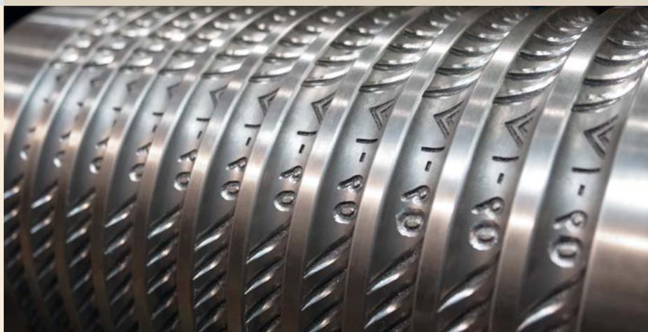
*Rodillo de laminación. Moderno sistema de acabado de las barras de construcción, adecuado para obtener elevados ritmos de producción.*
